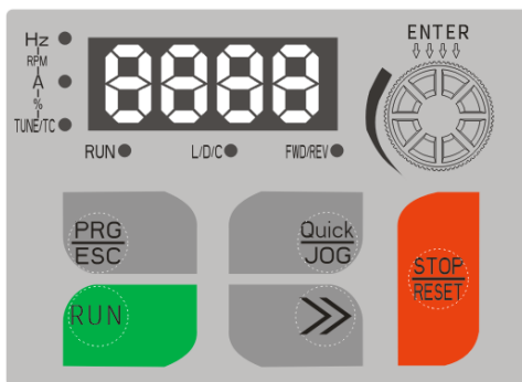
图4-2. 选配键盘示意图2(选配LED键盘2，如需选择该键盘，在订货时需说明)
